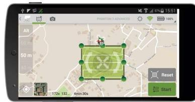
Hình 7: Phần mềm điều khiển Pix4D capture Flight Operation
