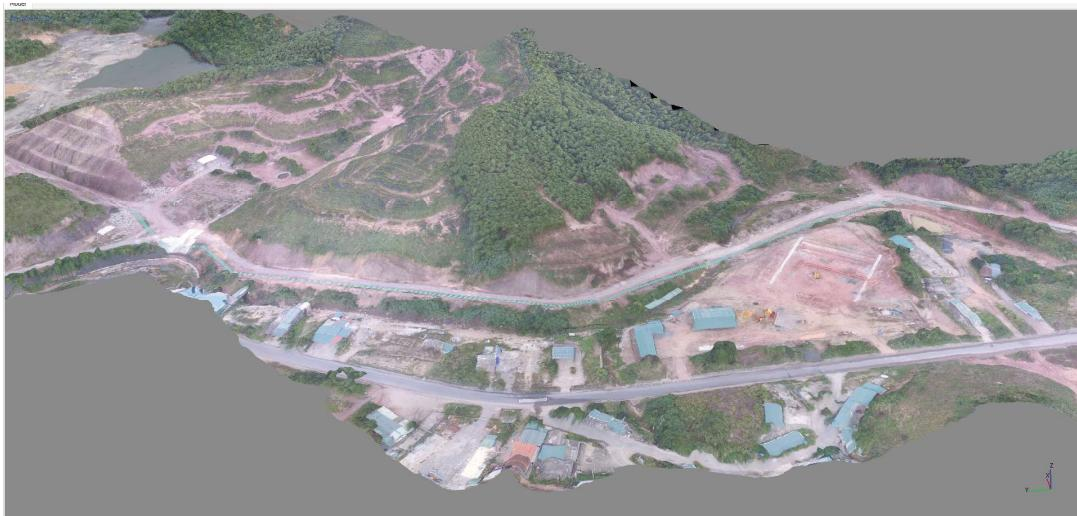
Hình 19: Hình ảnh 3D địa hình được xây dựng từ ảnh UAV
